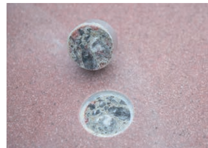
Die Überprüfung des Untergrundes auf seine Festigkeit brachte beste Werte: 4,970 N/mm 2 wurden erreicht.
